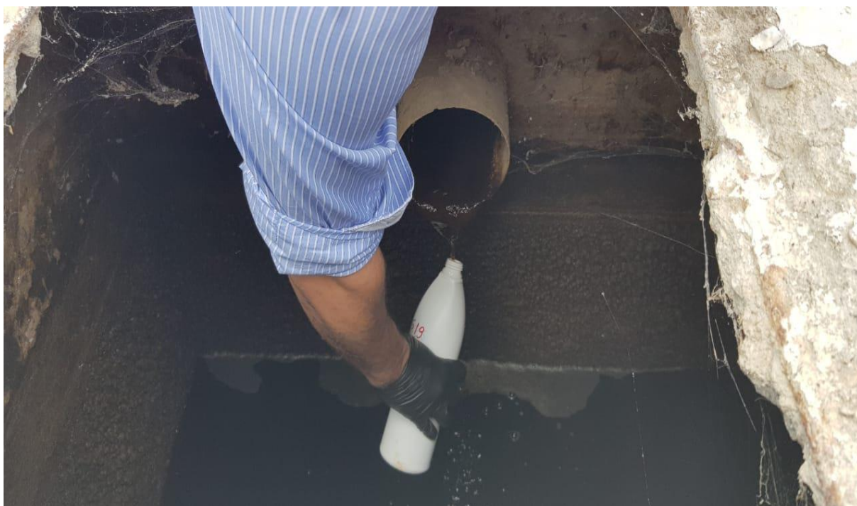
FOTO 24- Imagem detalha a coleta do chorume para análise.
